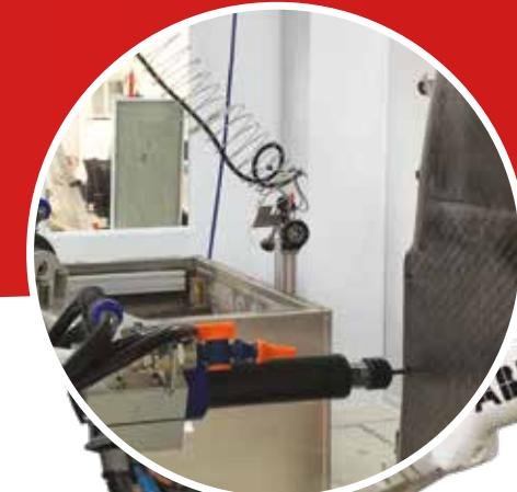
SandRob también puede realizar funciones de corte, contorneado y taladrado para permitir operaciones tales como eliminación de rebabas, de cualquier espesor, la apertura de agujeros, así como ranuras y taladrado, corte y pegado de paneles.
