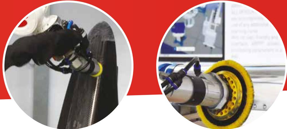
SandRob le permite realizar el **pulido** de forma rápida y uniforme para necesidades funcionales o estéticas, con uso combinación de papeles abrasivos y herramientas especiales con pasta abrasiva.
