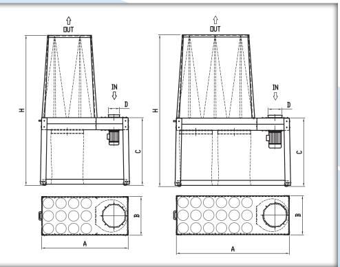
Sistema de aspiración y filtración portátil diseñado para uso junto a las máquinas para aspiración y extracción de polvo y viruta de madera, cuero, papel, plástico, goma, materiales compuestos o composites etc...
