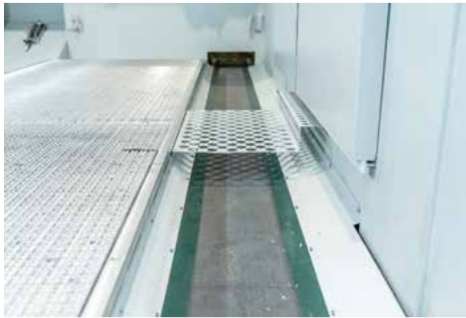
Cinta transportadora para la evacuación de virutas
