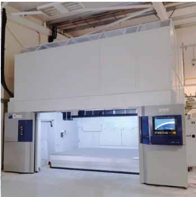
Cabina insonorizada integral para la contención del polvo, equipada con iluminación interior
