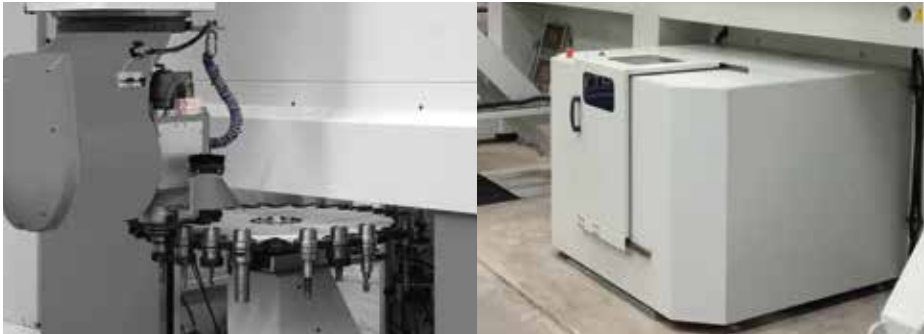
Vista interna y externa del almacén de cambio herramientas de 30 estaciones
