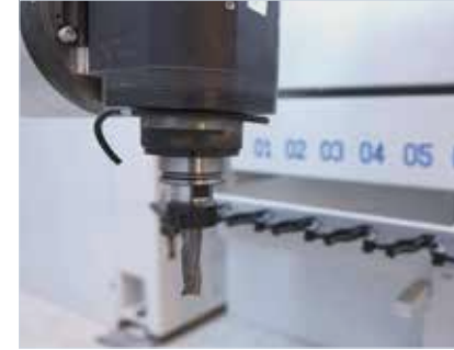
Almacenes de cambio de herramienta hasta 64 estaciones
