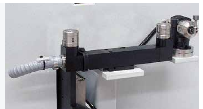
Sistema de realineación de los ejes rotatorios con láser para medir la longitud y los diámetros de los instrumentos
