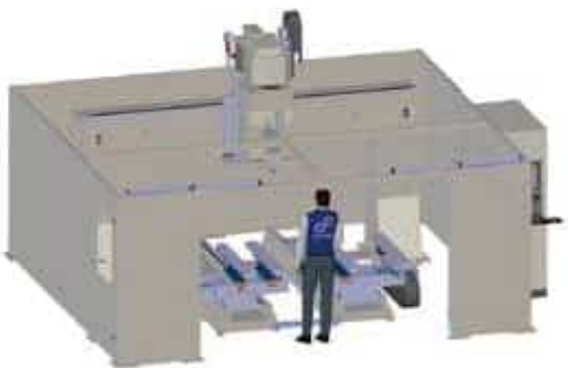
Funcionamiento en modo tablas unidad (modo TANDEM)
