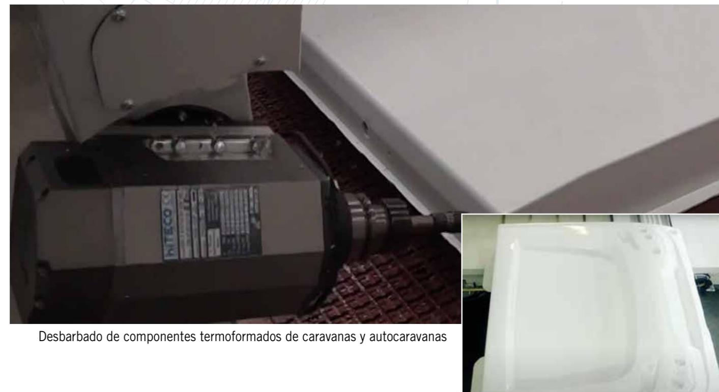
Desbarbado de componentes termoformados de caravanas y autocaravanas
