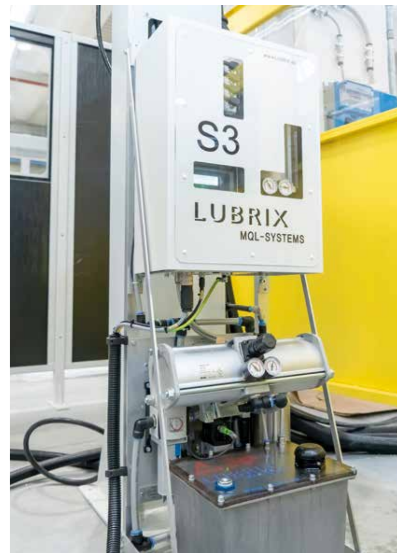
SISTEMAS MQL Máxima eficiencia con mínimo consumo de lubricante. Los sistemas MQL, en asociación con electromandriles que permiten el paso de aire/aceite dentro de la herramienta, garantizan una perfecta lubricación incluso en situaciones críticas.
