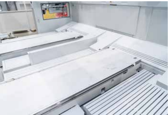
Cubetas de aspiración fijas en los laterales de las mesas
