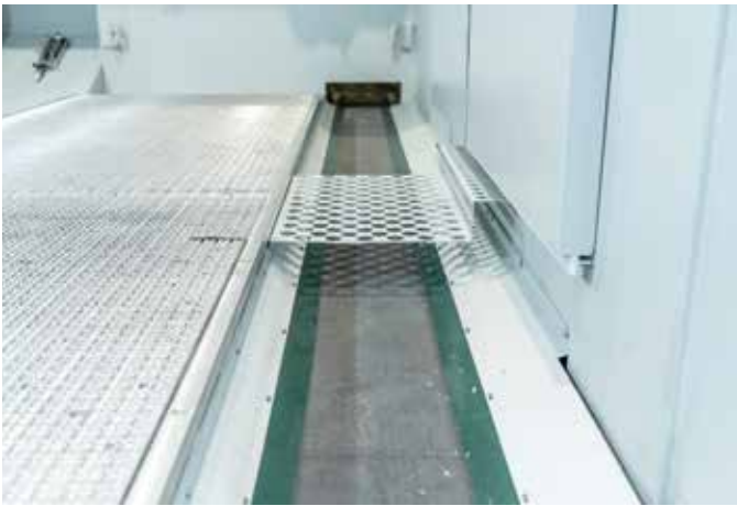
Cinta transportadora para la evacuación de virutas
