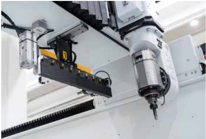
Almacén cambio de herramienta bajo el travesaño
