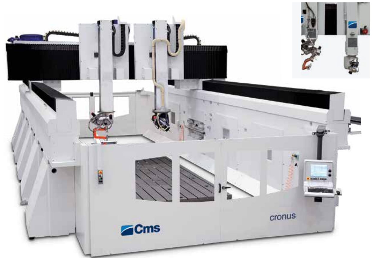
SOLUCIÓN HÍBRIDA 5-EJES: FRESA + CORTE POR CHORRO DE AGUA CATCHER
