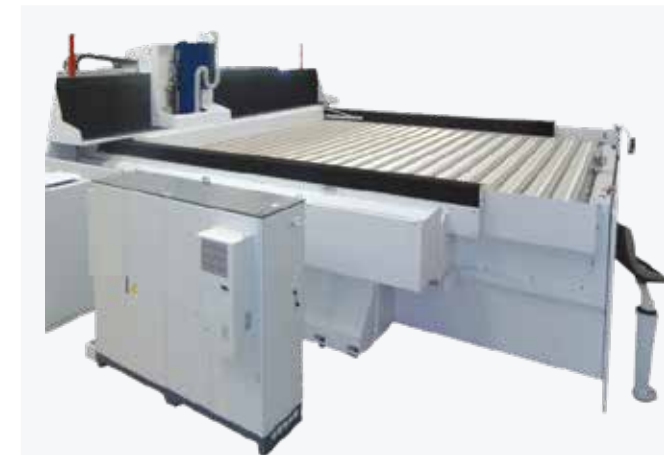
Cierre superior de fuelle para contener el polvo y las virutas
