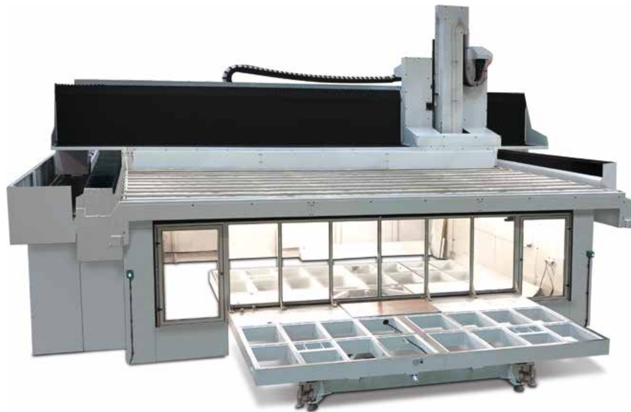
MESA GIRATORIA: SIMPLIFICA LA CARGA/DESCARGA FUERA DE LA MÁQUINA Y PERMITE EL CICLO PENDULAR USANDO EL ÁREA DE TRABAJO COMPLETA
