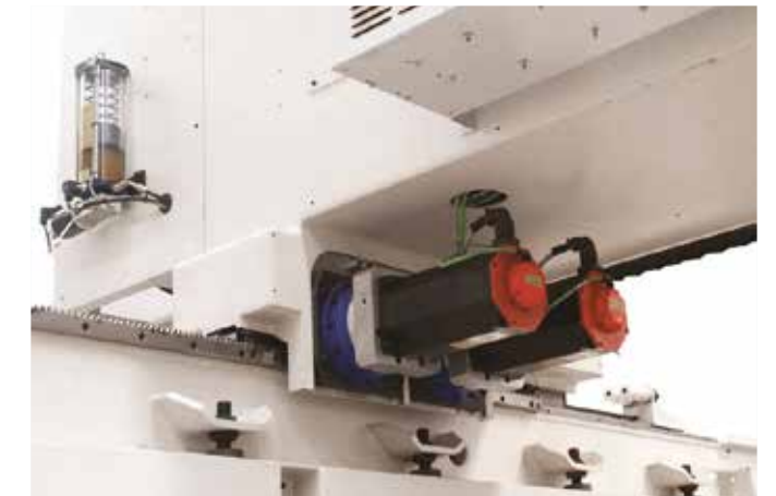
Concept incorpora la cinemática con recuperación del juego eléctrico (doble motor) a las excelentes prestaciones de poseidón.
